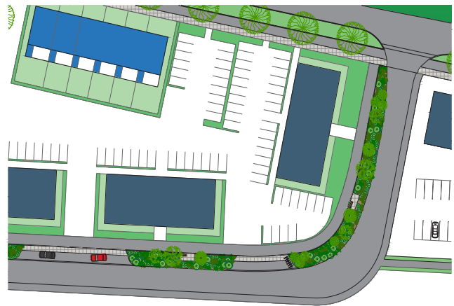
Bild 22. Utsnitt från illustration över Håkans Väg, regnbäddar med släpp.
